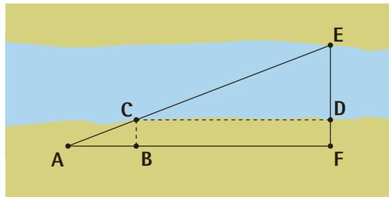
Si  $\overline{AB} = 15$  m,  $\overline{AF} = 60$  m y  $\overline{CB} = 7.5$  m, ¿cuánto mide el ancho del río?
