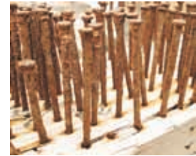
La oxidación de un clavo es un cambio químico que ocurre porque el hierro del que están hechos y el oxígeno del aire reaccionan formando óxido de hierro.
